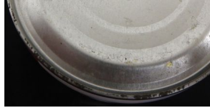
写真. 容器包装の外側の凹み、サビ（一例）
